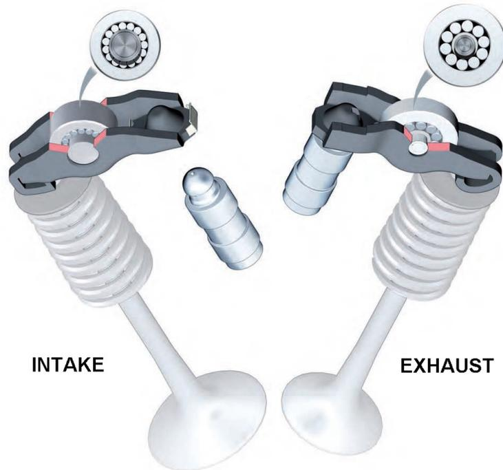
**2.0L 4V TFSI Engine Valvetrain**
